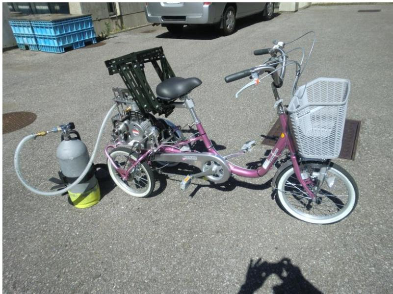
図1 回生機構付きエアモータ搭載自転車
